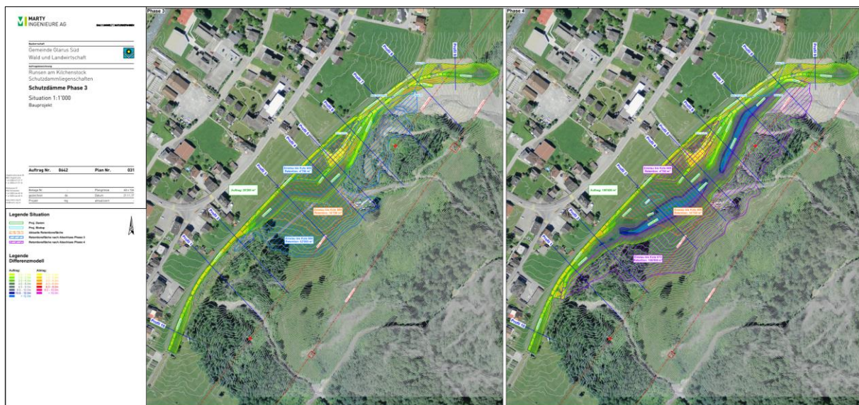
Abb. Nr. 3 Schutzdämme Phase 3 (in Ausführung) links und Schutzdämme Phase 4 (geplant) rechts
